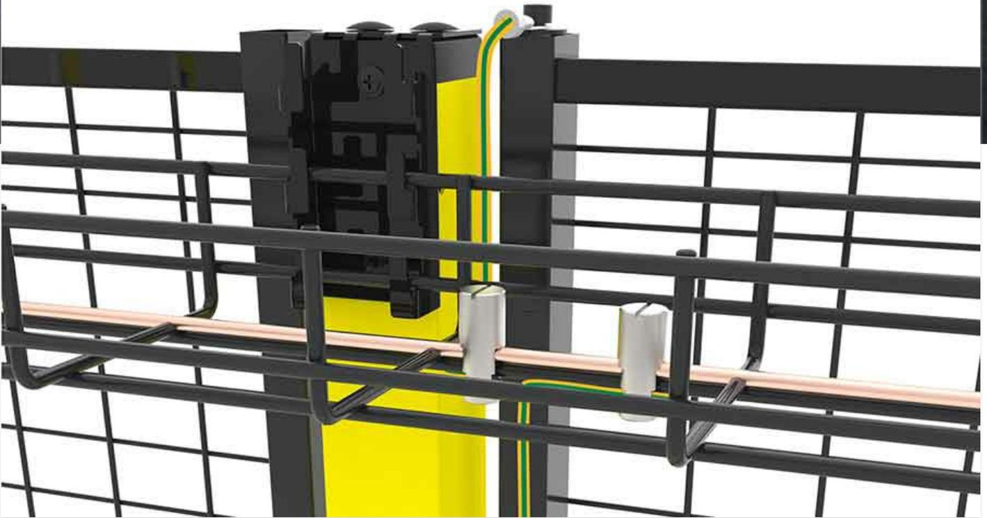
ชุดประกอบด้วยตัวเชื่อมต่อ “plug-and-play” สำหรับเสาและแผง ซึ่งถูกประกอบไว้ล่วงหน้าพร้อมกับสกรูขันและสายเชื่อมต่อ ตัวเชื่อมต่อสำหรับเสาถูกเลื่อนไปผ่านรูคีย์รูหนึ่ง ตัวเชื่อมต่อสำหรับแผงถูกเลื่อนไปยังท่อกรอบแนวตั้งจากด้านบนหรือล่าง หลังจากขันแน่น การเชื่อมต่อที่ดีจะเกิดขึ้น การใช้งานชุดนี้ได้รับการทดสอบอย่างประสบความสำเร็จตาม IEC 61537 ส่วน 11.1.2 โดยสถาบันรับรองอิสระ
