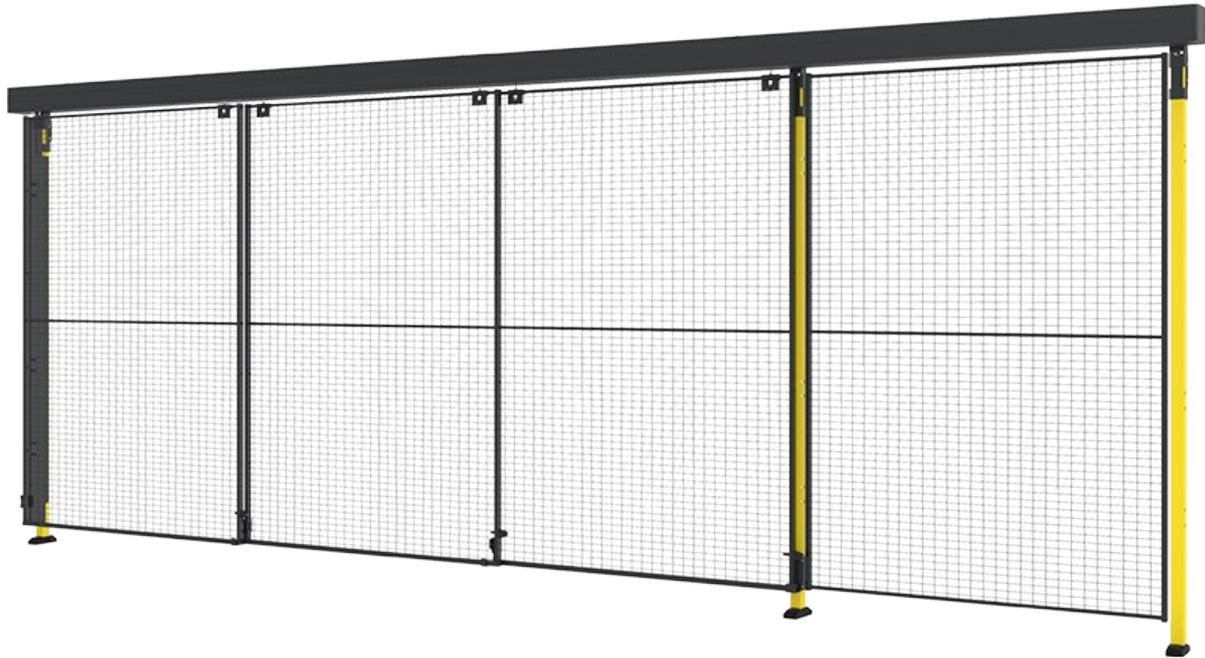
ประตูเลื่อนแบบสามชั้น X-Guard ถูกออกแบบมาสำหรับสภาพแวดล้อมในอุตสาหกรรมที่ต้องการเปิดกว้างขนาดใหญ่แต่มีพื้นที่จำกัดสำหรับประตูเลื่อนแบบดั้งเดิม โดยมีระบบราง 3 ชั้นตอน ทำให้แผงทับซ้อนกันแทนที่จะเลื่อนไปข้างนอกทั้งหมด ลดความจำเป็นในการเว้นพื้นที่ข้างเคียงในขณะที่ยังคงรักษาการเข้าถึงที่ง่าย ด้วยความกว้างสูงสุด 3x1500 มม. และความสูง 2500 มม. มันจึงเป็นทางเลือกด้านความปลอดภัยที่มีประสิทธิภาพและใช้งานได้จริง
